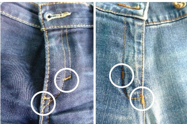
Ein innerer oder äußerer Schlussriegel sollte verwendet werden, um den Reißverschluss vor Beschädigungen zu schützen, die bei speziellen Prozessen bei der Herstellung von Bekleidung verursacht werden können. Die Schlussriegel schützen die Reißverschlüsse auch, wenn der Träger versehentlich auf das Kleidungsstück tritt.
