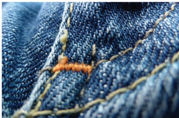
Die Schlussriegel verhindern Schäden während des industriellen Waschens (Enzym- / Stein- oder Bleichwaschverfahren), wo die Ladekräfte mehr als das 100-fache eines Hauswaschprozesses oder die erwarteten Belastungen während des normalen Verschleißes des Kleidungsstückes betragen können.
