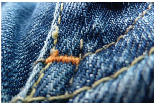
Les renforts évitent les détériorations dues au délavage industriel (aux enzymes, à la pierre ou au chlore), car la charge et la force exercée peuvent être 100 fois plus importantes que lors du lavage domestique ou les tractions liées au port du vêtement dans des conditions normales.
