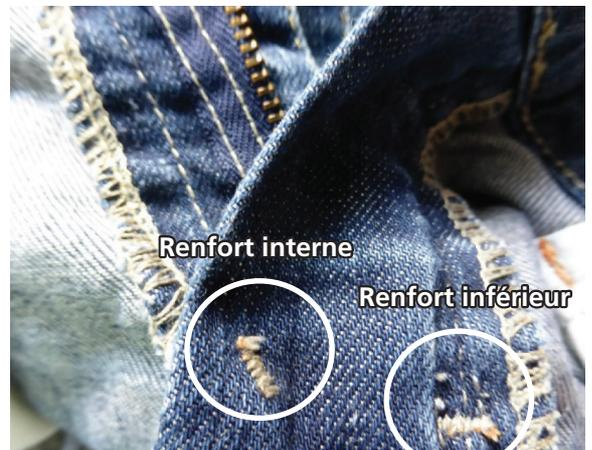
S'il est correctement réalisé, le renfort offre normalement une protection trois à quatre fois supérieure à celle des dents et de la butée inférieure de la fermeture. Une ligne de points simple ou double n'offre pas une protection suffisante et peut facilement se défaire pendant le délavage, ou si l'utilisateur se sert d'objets susceptibles d'endommager les éléments de la fermeture à glissière.
