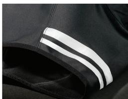
Transfer film elastis Signal terbuat dari manik-manik kaca berperforma tinggi yang dilaminasi untuk lapisan polimer tahan lama dengan perekat reaktif panas di sisi belakangnya. Produk ini diaplikasikan baik pada pakaian jadi atau lembaran kain dengan menggunakan tekanan panas.
